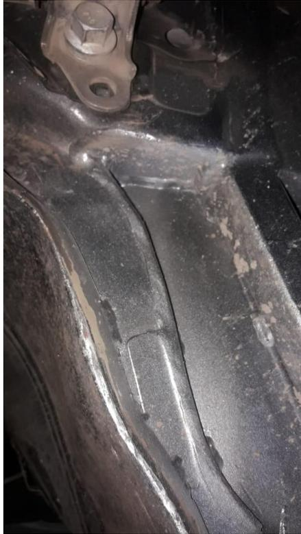
26. Se permite practicar un orificio ventana para la colocación de bulones pasantes en el torpeda, que fijen el puente sostén del motor – caja de velocidades.
